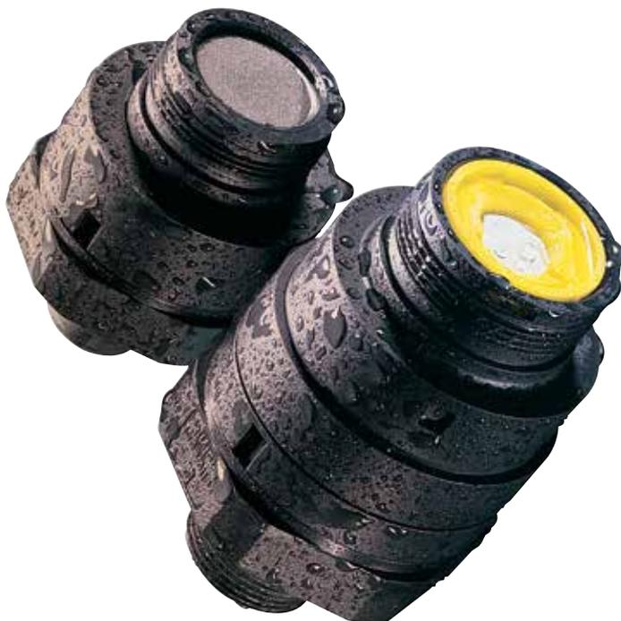
Der Detektor für brennbare Gase ist in Ausführungen für die Messung in % UEG oder PPM- erhältlich und mit einem branchenüblichen mV-Brückensignalausgang ausgestattet. Die typische Lebensdauer beträgt über 5 Jahre. Nach Ablauf der Lebensdauer wird der Detektor einfach durch einen neuen ersetzt.
